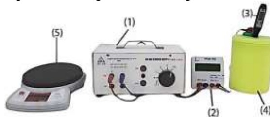
Hình 4.1. Bộ thiết nghiệm thực hành đo nhiệt dung riêng của nước
